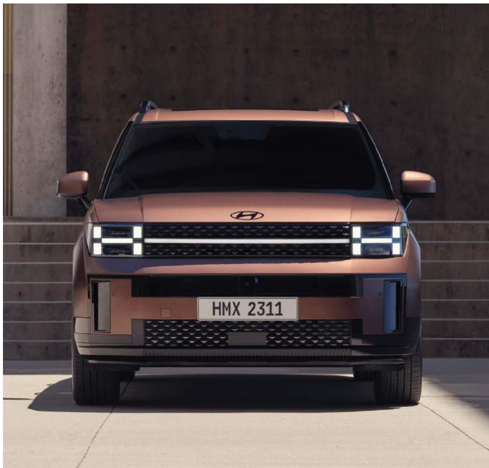
H-образные фары головного света (светодиодные, проекционного типа)
